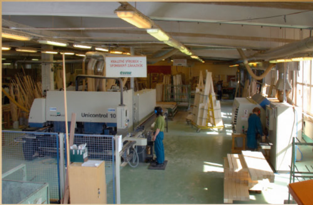
Obráběcí CNC-automatická linka od firmy WEINIG
